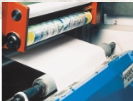
**BlueLight® UV-Systeme für die Druckfarbenhärtung** – Trocknen ohne Wärme ist vorteilhaft für Folien und andere temperatur-empfindliche Materialien.
